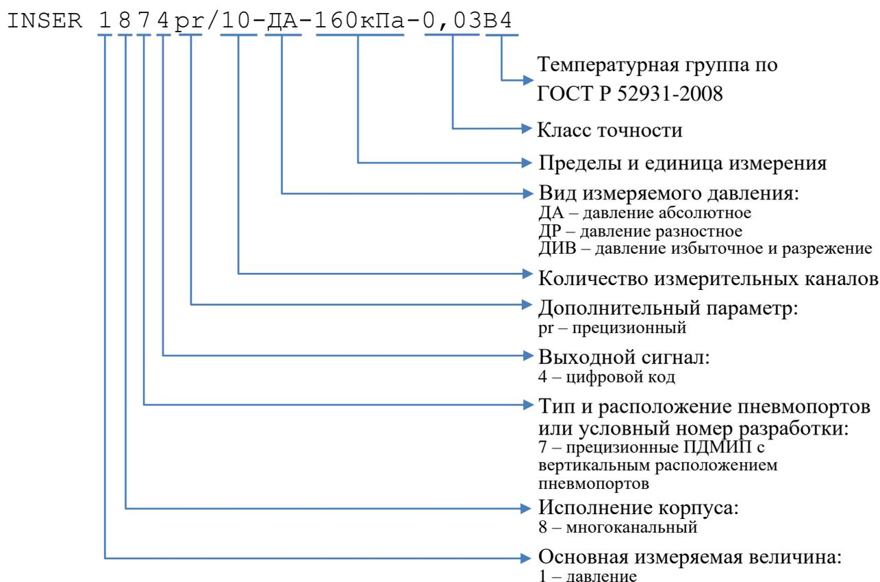
Рисунок 1 – Структура условного обозначения ПДМИП Inser 1874
